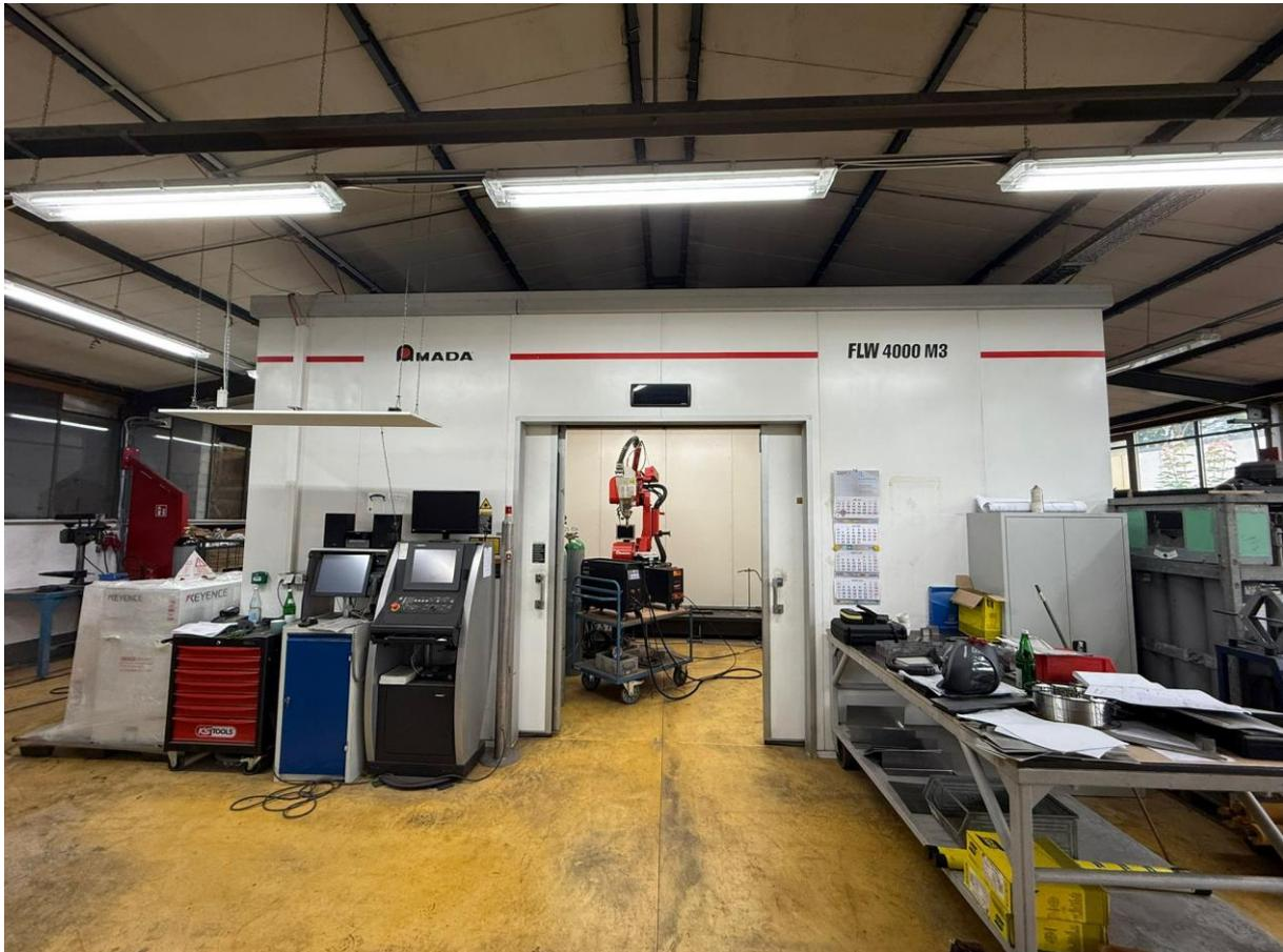
Die FLW ist eine flexible und hochproduktive Laser-Schweißzelle mit umfangreicher Ausstattung. Der fokussierte Laserstrahl wird als Energiequelle eingesetzt um Materialien aufzuschmelzen bzw. miteinander zu verbinden.
